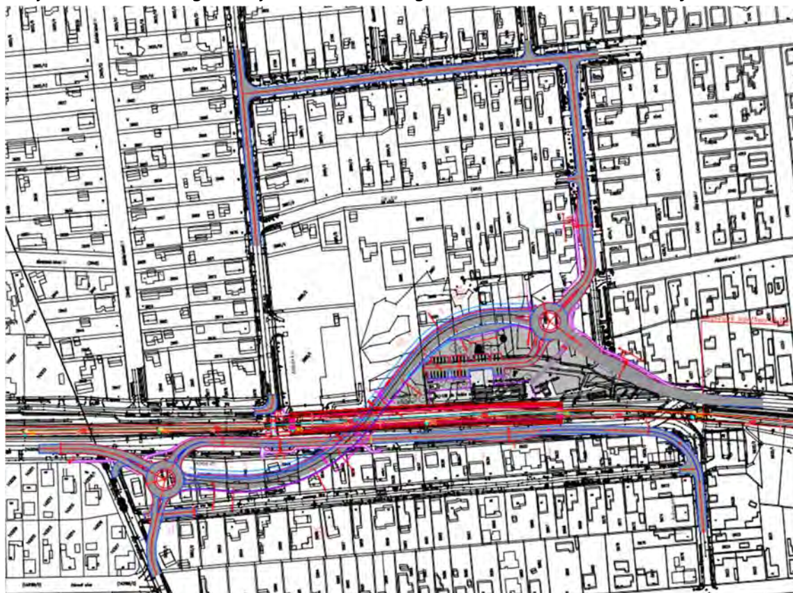
Gyál Kőrösi úti új közúti aluljáró helyszínrajza Gyál felső vasúti megállóhely térségében
